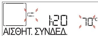
Επιλέξτε τη λειτουργία που επιθυμείτε από αυτές που είναι συμβατές (Συμβατικό, Εξαναγκ. αέρας, Συμβατ. ψήσιμο, Turbogrill, Εξαν. αέρ. Eco, Maxi Cooking, λειτουργίες 6<sup>th</sup> Sense): Η οθόνη σας προτρέπει να ρυθμίσετε τη θερμοκρασία-στόχο του καθετήρα: Πιέστε + ή — για να ρυθμίσετε και πιέστε ✓ για να ρυθμίσετε τις ακόλουθες παραμέτρους ψησίματος.
